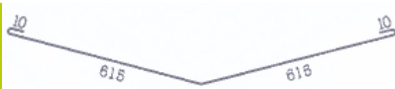
Поперечное сечение планки для внутренних стыков, изготовленной из гладкого стального листа.
